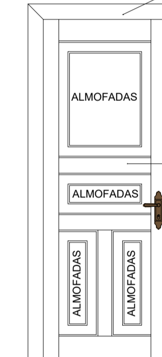
P5 - 80 X 210 CM (X10) ESC: 1/25 ACABAMENTO: EMASSAMENTO A ÓLEO E PINTURA EM ESMALTE SINTÉTICO COR CINZA CLARO.
