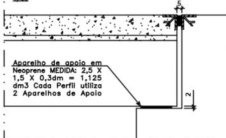
DETALHAMENTO APARELHO DE APOIO 1/50
